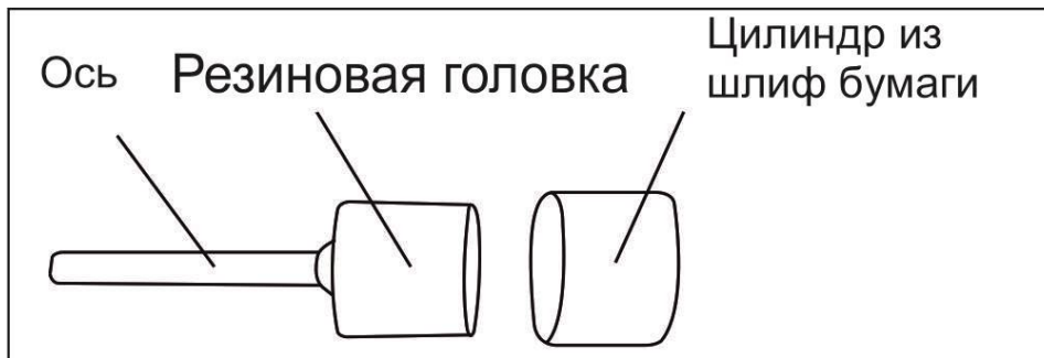
Рис.6 Установка цилиндра из шлиф бумаги
